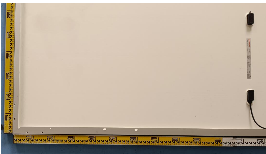
图 18 接地孔及安装孔位置
